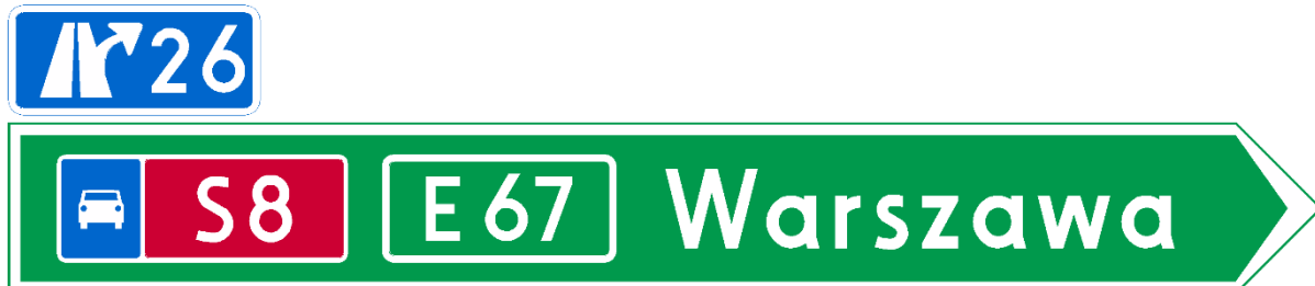
Rys. 5.2.15. Drogowskaz E-103 ze znakiem T-133 na wyjeździe z autostrady prowadzącym na drogę ekspresową
