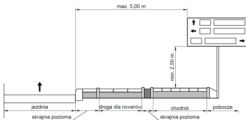
Rys. 5.4.2. Wysokość umieszczenia znaków w przekroju drogowym z drogą dla rowerów
