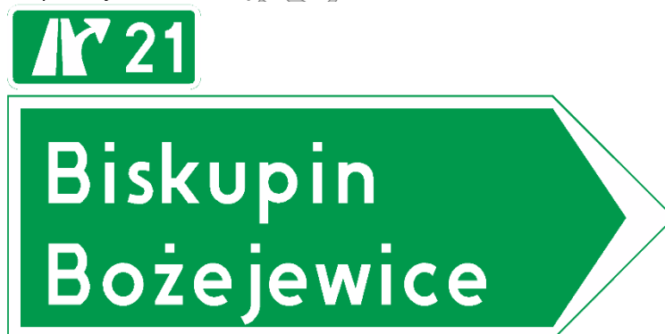
Rys. 5.2.17. Przykład stosowania drogowaskazu E-103 w przypadku prowadzenia ruchu do drogi innej niż krajowa czy wojewódzka, czyli do drogi bez przedstawianego numeru drogi na oznakowaniu kierunkowym
