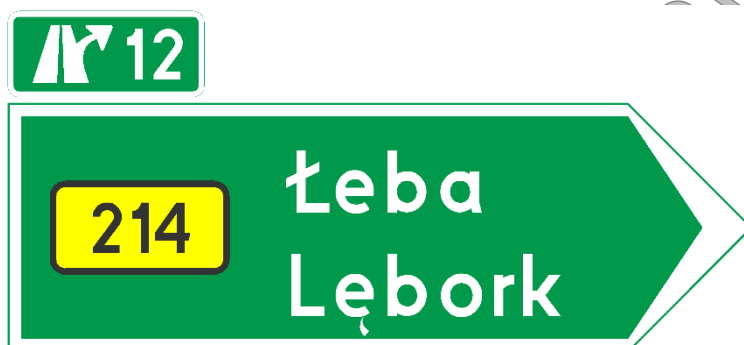
Rys. 5.2.16. Drogowskaz E-103 ze znakiem T-133 na wyjeździe z drogi ekspresowej prowadzącym na drogę wojewódzką
