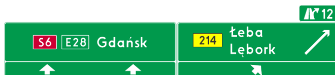
Rys. 5.2.11. Przykład drogowaskazu tablicowego E-102c lokalizowanego na jezdni 2 pasowej drogi ekspresowej krzyżującej się na węźle drogowym z inną drogą (droga wojewódzka)
